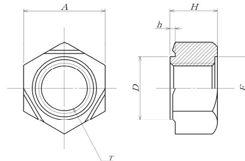
相手部材に3カ所の突起部を直接熔接して固定します。
